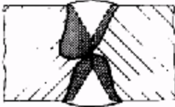
Şekil V.10.- Ark üflemesinin dikişin iç formu üzerindeki etkisi (birleşme kifayetsizliği).
