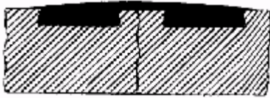
Şekil XVI.22.- Kalın cidarlı dökme parçalarda, çatlağın her iki tarafına genişçe birer kırlangıç kuyruğu oyuk açarak püskürtme.
