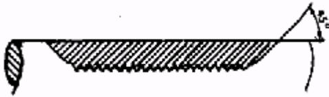
Şekil XVI. 13.- Bir milin doldurulmasında, esas metal ile püskürtülen tabaka arasındaki geçiş durumu.
