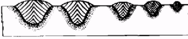
Şekil V.5.- Kaynak hızının dikiş formu üzerindeki etkisi (şematik)
