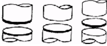
Şekil XVIII.6.- Difüzyon kaynağının esası,
