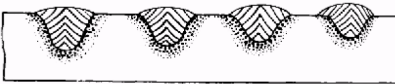
Şekil V.4.- Tel çapının dikiş formu üzerindeki etkisi (şematik)
