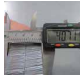
Karbon Çeliği Temiz Kesme Yüzeyi ve Max. Kesme Kalınlığı
